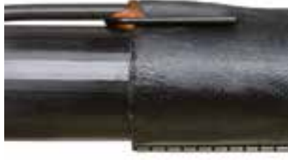
Přerušené propojení stínění pro transpozici
